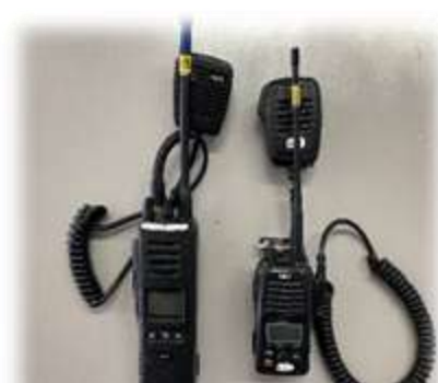
消防救急デジタル無線
